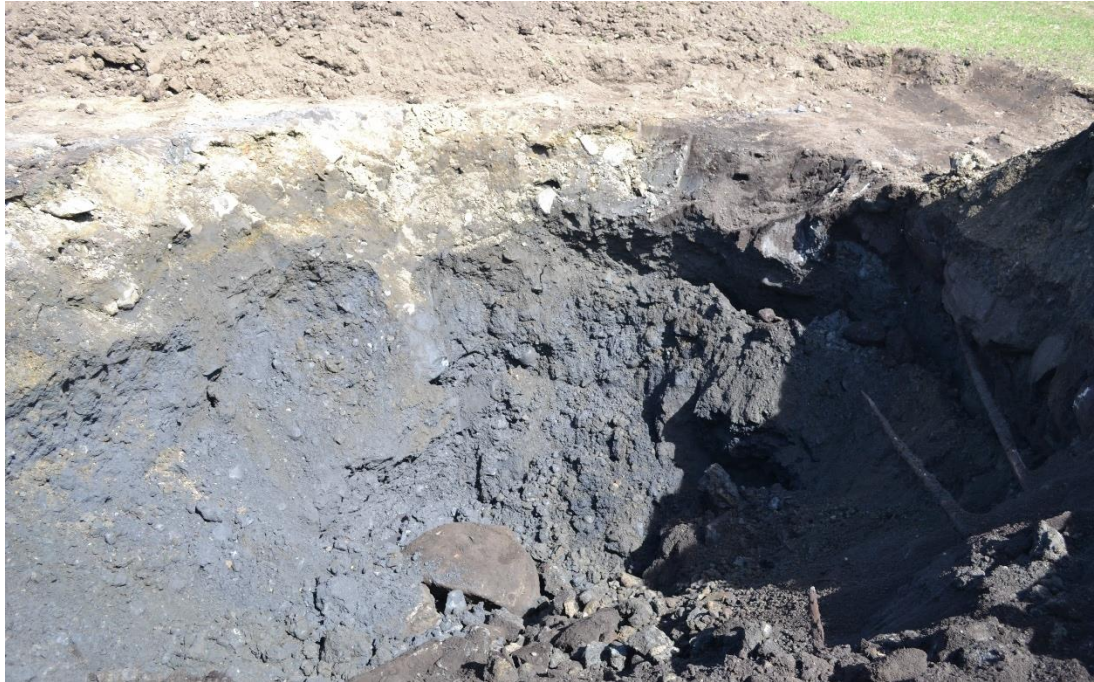
Sjaktning med gravemaskin: Fast mørk grå moreneleire i dypereliggende lag
